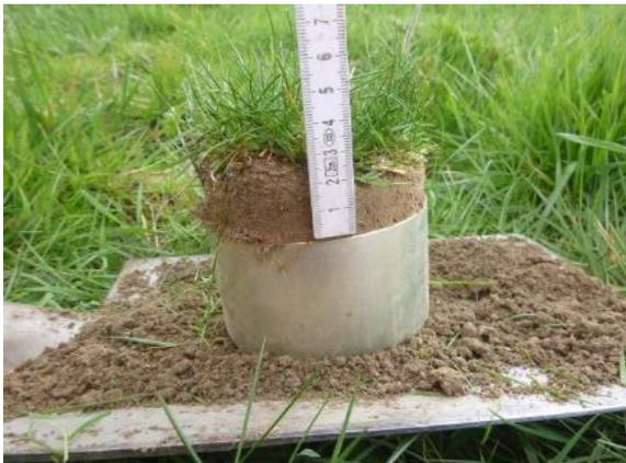
Herausdrücken des Bodenmaterials 0-2 cm aus dem Stechzylinder
