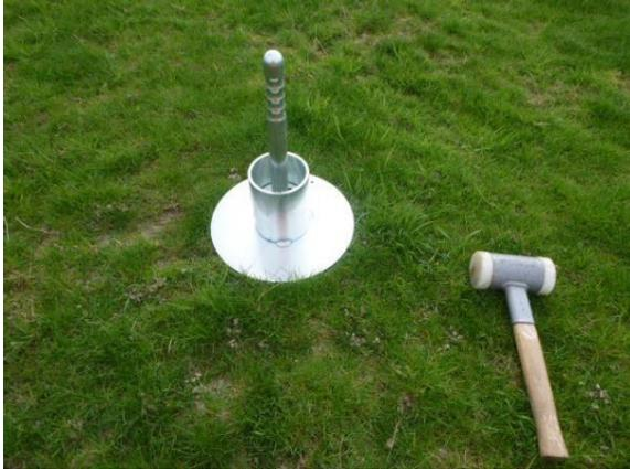
Eintreiben des Stechzylinders in den humosen Oberboden mittels Führungsring, Schlagaufsatz und Schonhammer
