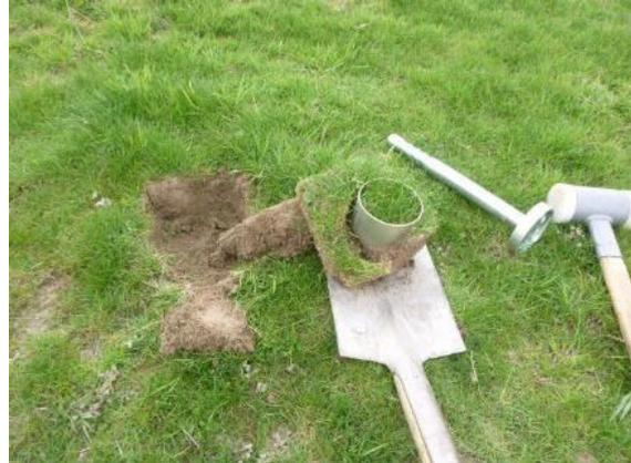
Entnahme des Stechzylinders mittels Spaten
