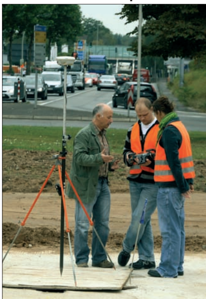
Abb. 4: Koordinatenbestimmung im Gelände mit SAPOS®
